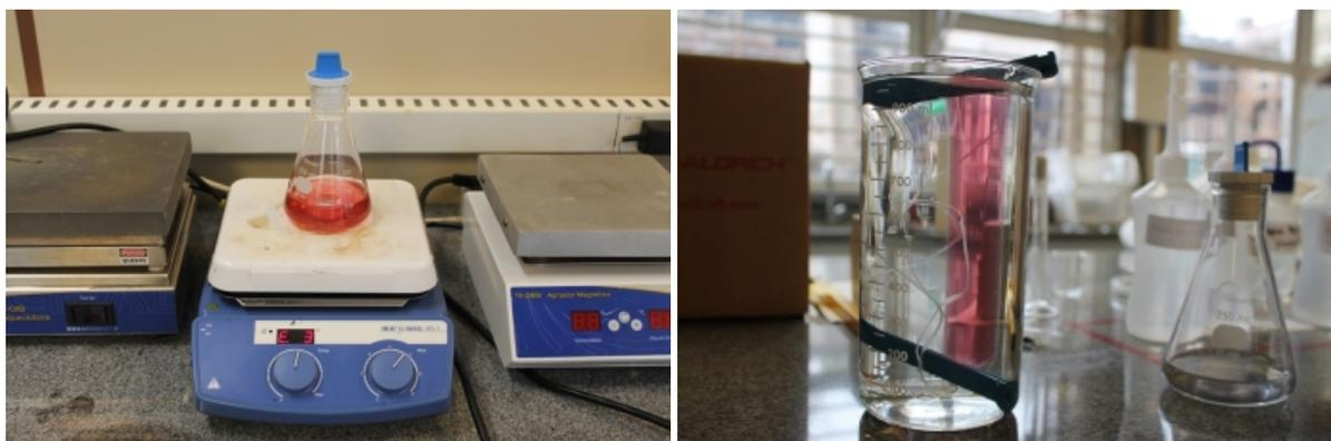
**Figura 4.19:** (a) Processo de síntese via Método 2 (Turkevich). (b) Processo de diálise da amostra E4.
