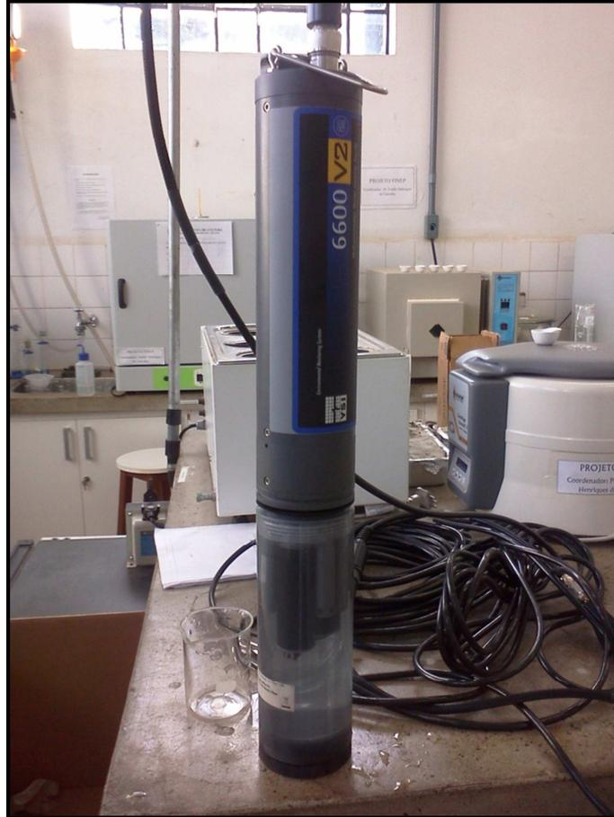
**Figura 20 - Sonda multiparamétrica YSI 6600 V2-2**
