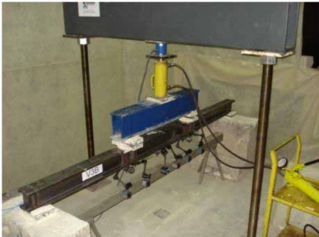
Figura 3.18 – Esquema montado para ensaio de viga
