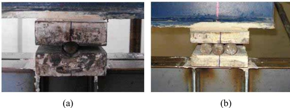
Figura 3.14 – Apoios da viga de transmissão de carga
