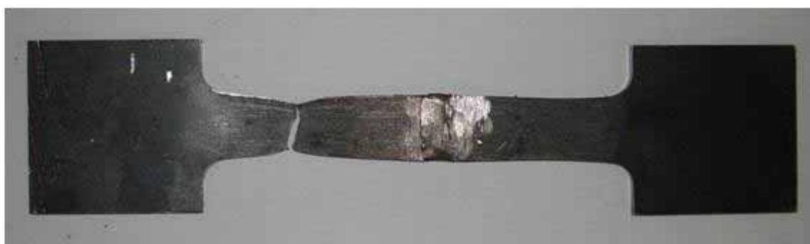
Figura 4.4 – Corpo de prova com emenda soldada rompido
