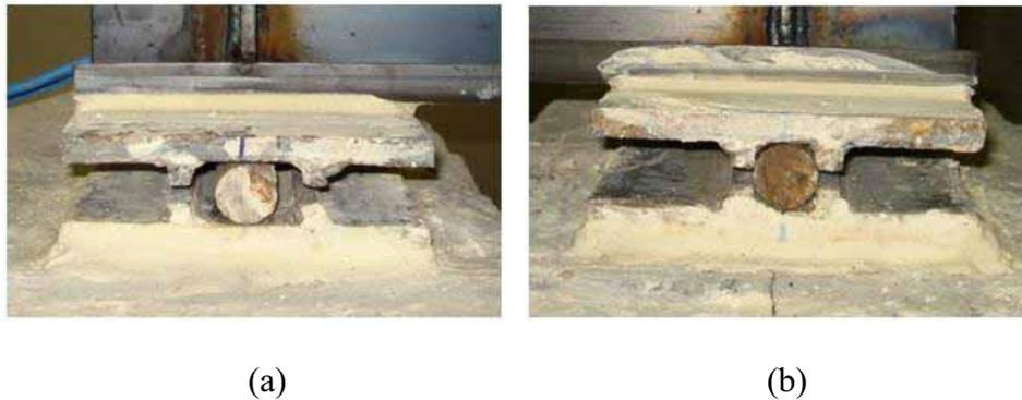
Figura 3.16 – Apoios das vigas de ensaio
