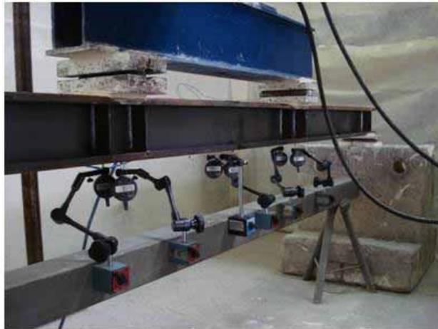
Figura 3.27 – Defletores posicionados na viga
