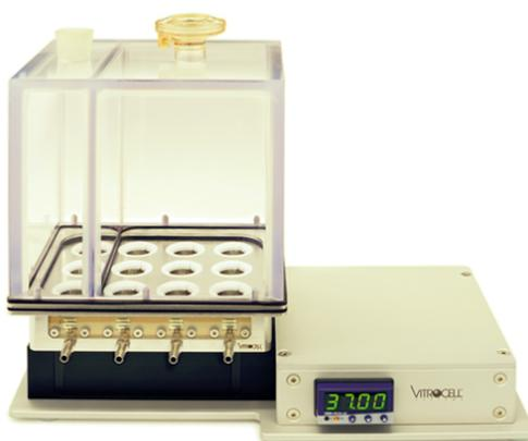
Figura 6: Imagem da câmara de Exposição com produção de aerossóis padronizados (4 – 6  $\mu\text{m}$ ).
