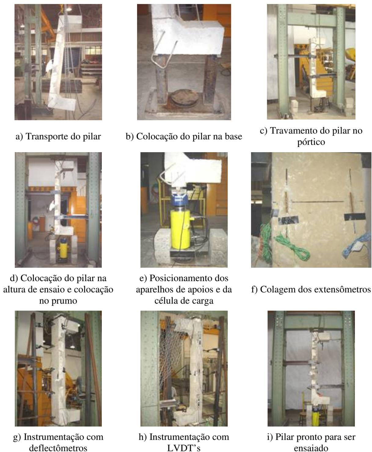
Figura 3.27 – Esquema de montagem do ensaio de pilar
