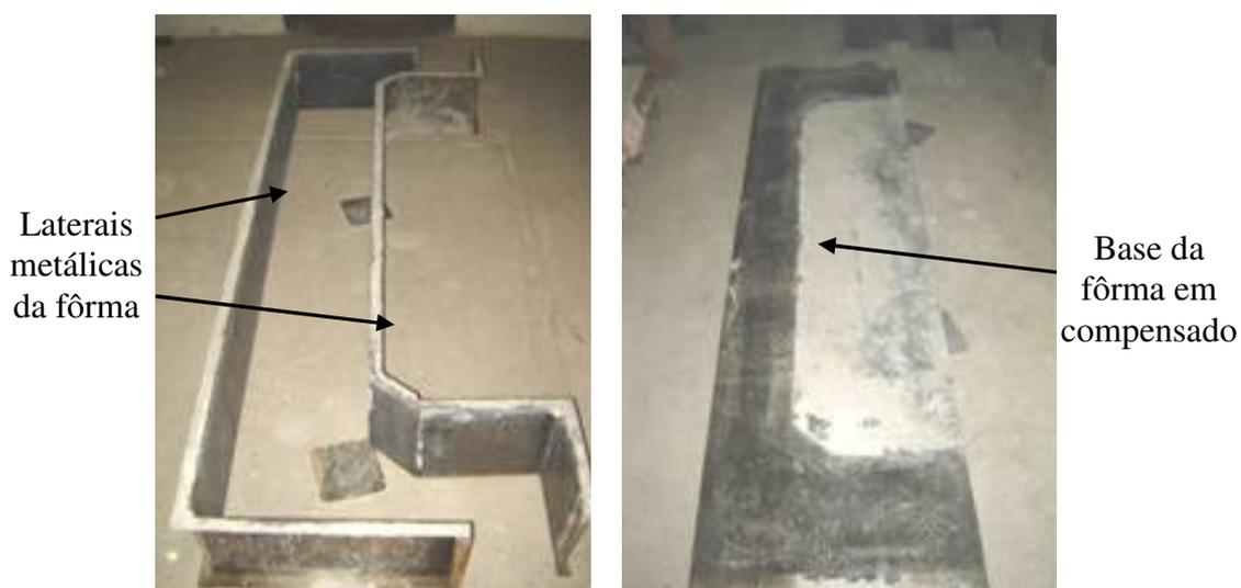
Figura 3.7 – Fôrma utilizada para moldagem dos pilares
