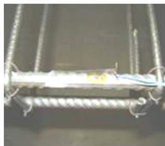
e) Colagem do extensômetro;
