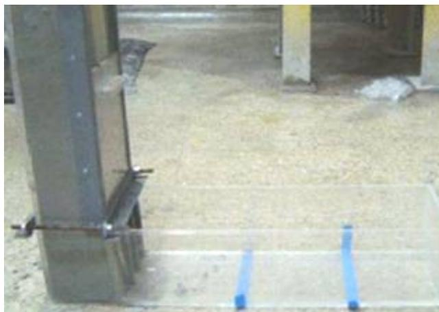
Figura 2.14 – Teste da caixa em L (LIMA, 2006)
