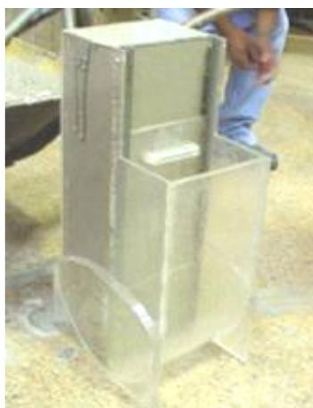
Figura 2.15 – Teste da caixa em U (LIMA, 2006)
