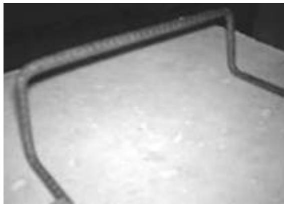
Figura 3.2 – Conector utilizado no reforço dos pilares
