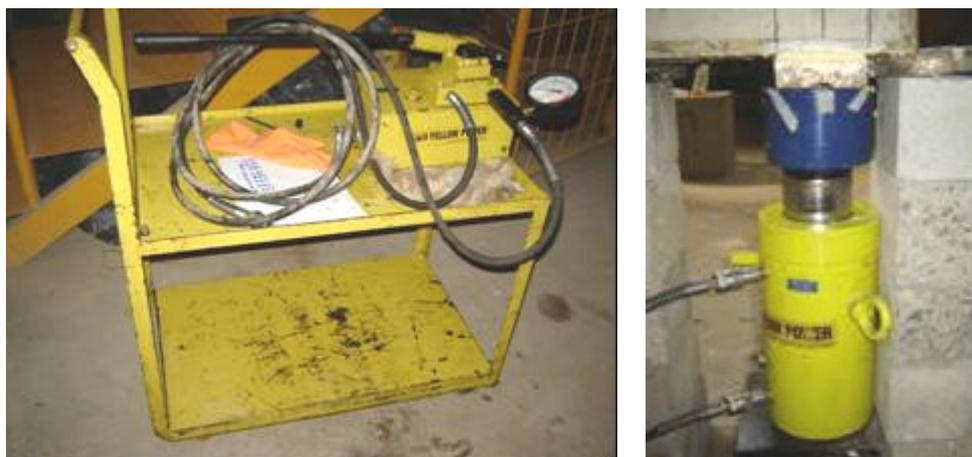
Figura 3.28 – Bomba manual e atuador hidráulico
