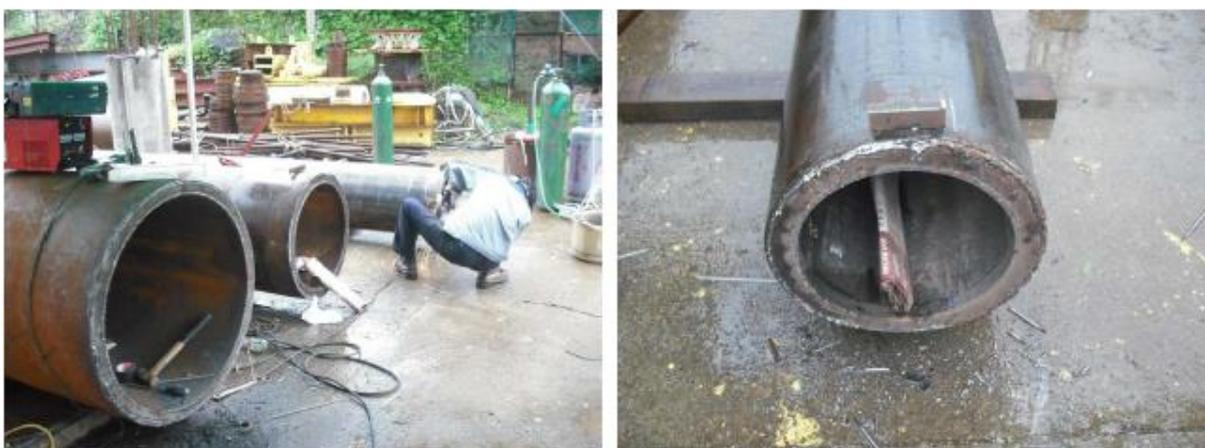
Figura 2.10 - Detalhe da instrumentação das estacas (KO; JEONG, 2015)
