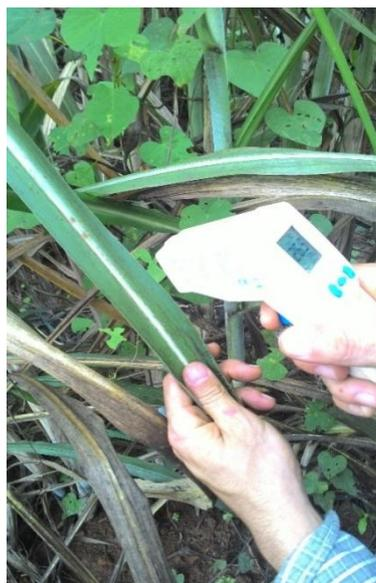
**Figura 7.** Termômetro digital laser de infravermelho (marca: Fluke, modelo 59 max+) utilizado para medir temperatura foliar da cana-de-açúcar, Goianésia,GO, 2016.
