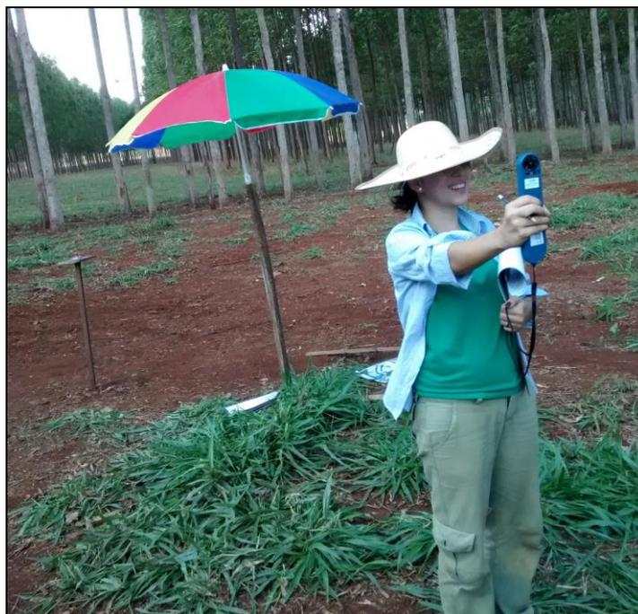
**Figura 5.3.** Aferição de temperatura (C°), umidade relativa do ar (UR%) e velocidade do vento (km) entre renques do sistema de integração lavoura-pecuária-floresta estudado.
