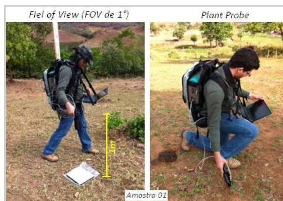
Figura 05 €Exemplos dos métodos de obtenção das assinaturas espectrais das pastagens (*Field of View* e *Plant Probe*), utilizando o espectrorradiômetro *FieldSpec-3*.
