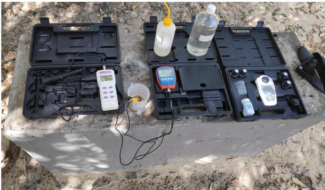
Figura 38: Equipamentos utilizados na medição da condutividade elétrica, turbidez, pH e temperatura da água.
