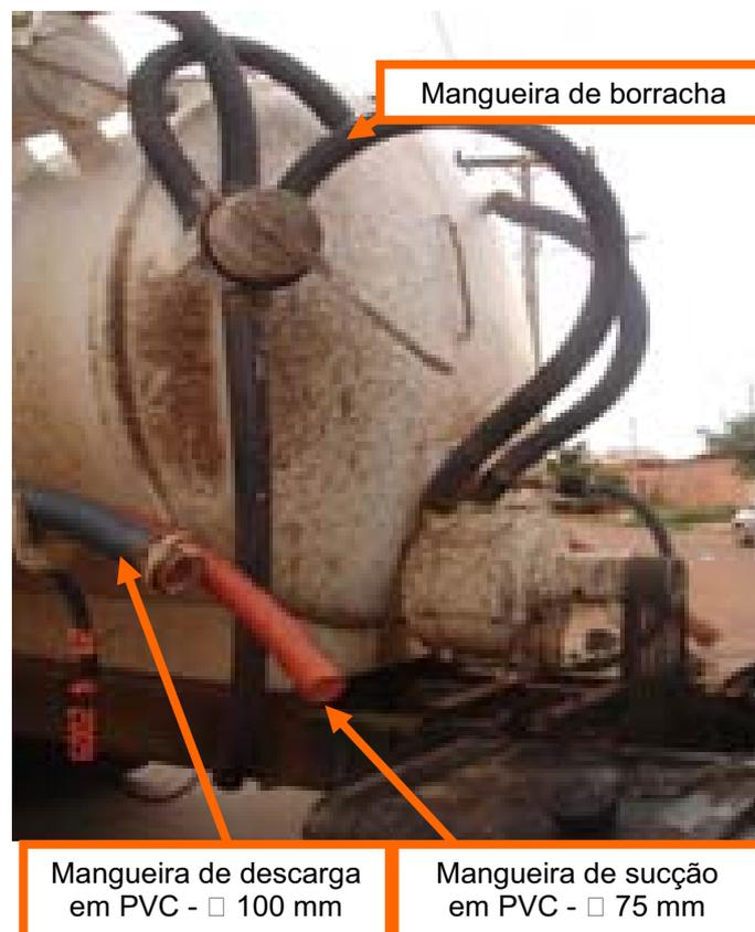
**Figura 29** – Destaque dos diversos tipos de mangueiras usadas em um caminhão limpa-fossa
