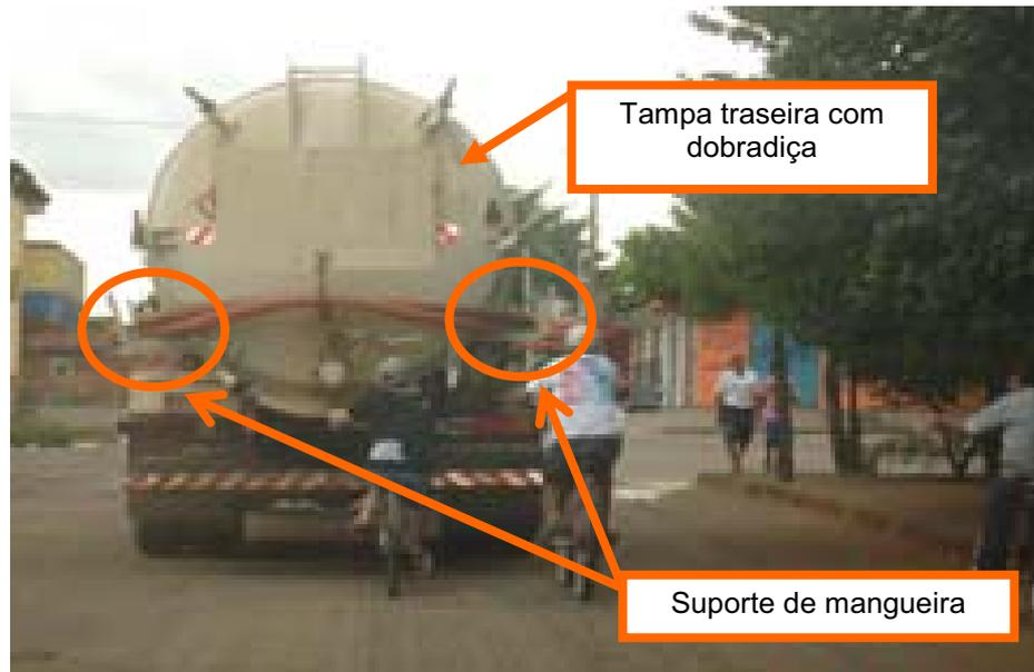
**Figura 28** – Detalhe do suporte de mangueira e da tampa traseira com dobradiça de um caminhão limpa-fossa
