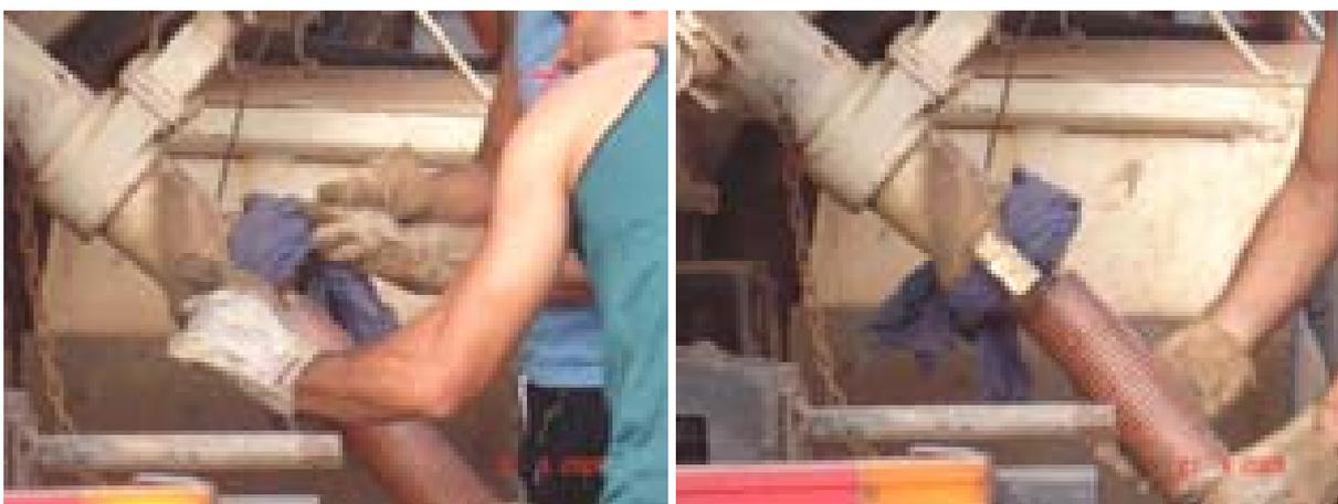
**Figura 30 – Exemplo de comprometimento da estanqueidade do sistema de sucção**
