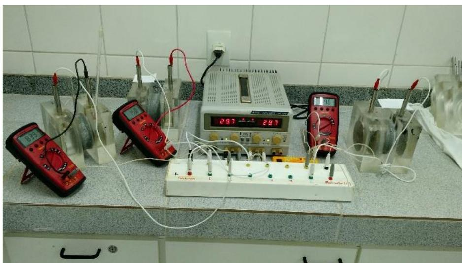
O ensaio foi realizado durante 6 horas e a cada 30 minutos a corrente passante foi aferida. Ao final, obteve-se a corrente total de acordo com a equação 3.1.
