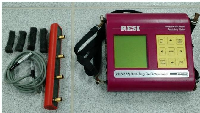
Figura 3.21 - Teste de resistividade elétrica no concreto.
