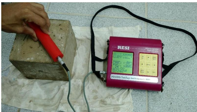
É importante ressaltar que foram realizadas duas medidas (diagonais) em cada face, exceto na face superior do CP, a qual corresponde à superfície livre no momento da concretagem e não foi imersa na solução de cloretos.
