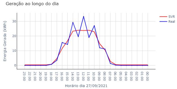
Fig. 29. Gráfico que representa a geração geral dia 27/09/2021 e a previsão feita pelo SVR com kernel RBF treinado com a variável irradiância.
