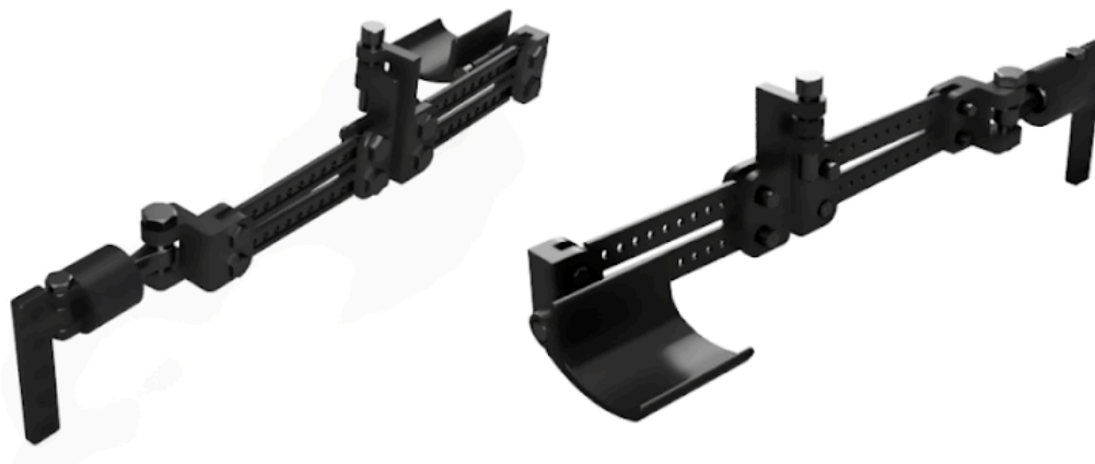
Figura 11 - Modelagem tridimensional do protótipo do exoesqueleto. Fonte: elaborado pelo autor.
