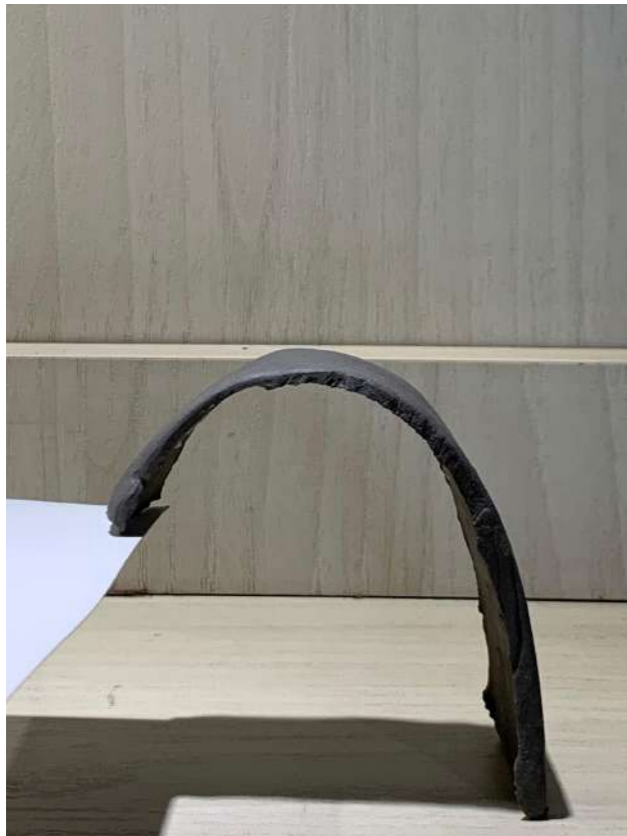
Figura 75: Maquete de estudo de argila de secção da abóbada vazada. Escala 1:100. Elaborada por Ana Coêlho.
