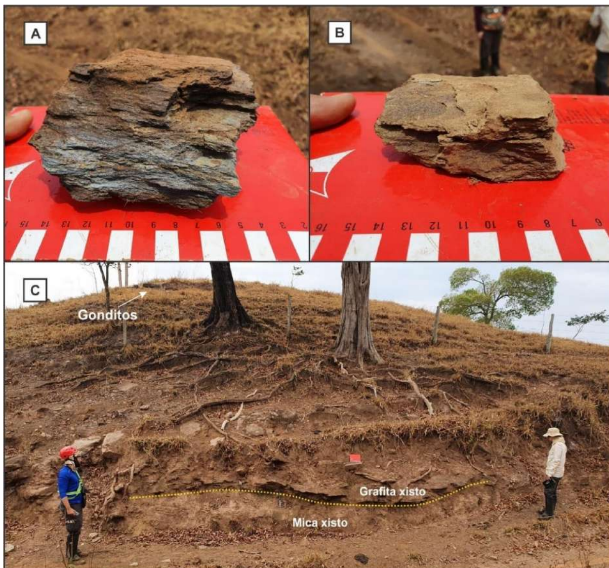
Figura 29: A) Amostra de grafita xisto extraída de afloramento. B) Amostra de muscovita xisto. C) Afloramento do ponto 22TF04-028 exibindo a presença de gonditos no relevo acima e mais abaixo uma lente de grafita xisto acima de uma camada de muscovita xisto.
