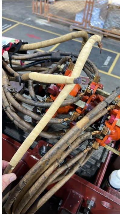
Figura 16 – Comutador de derivação sem tensão (CDST) reparado
