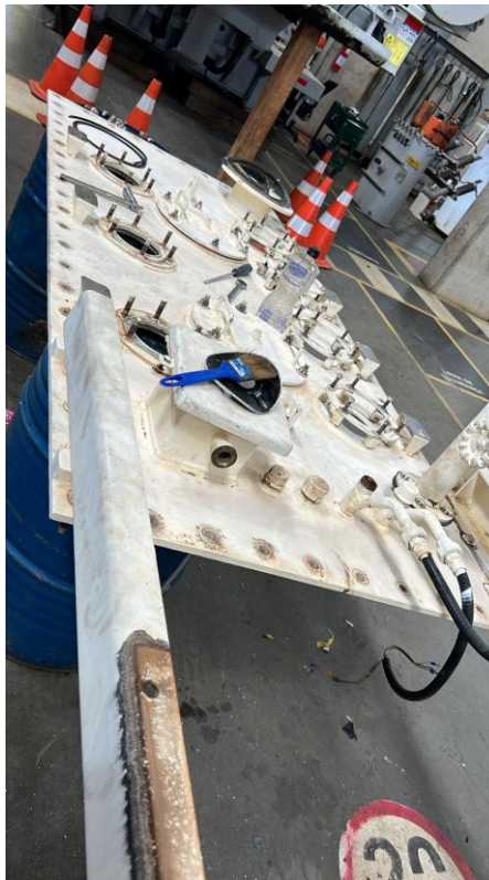
Figura 10 – Troca das juntas de vedação
