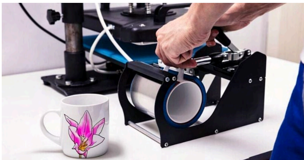
Figura 46 - Processo de sublimação em uma caneca de cerâmica.
