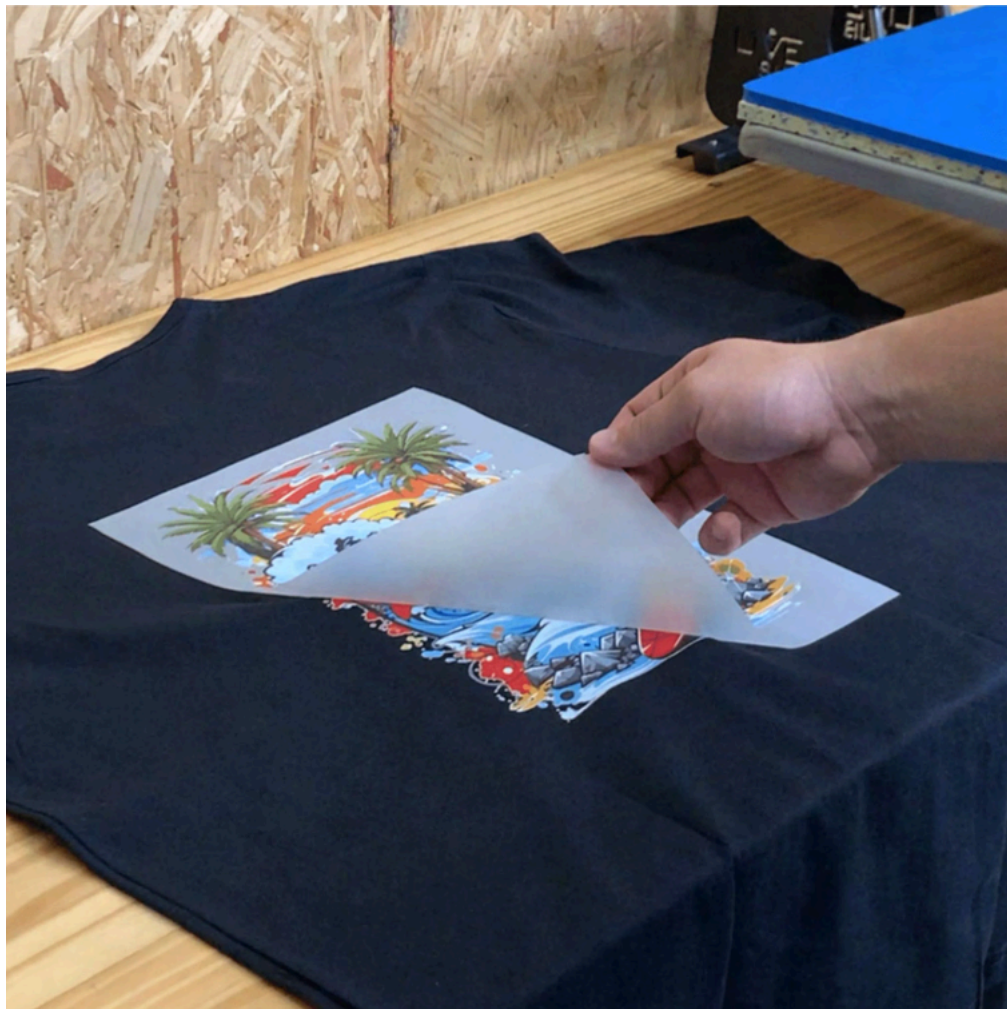
Figura 47 - Retirada do papel sobre a estampa após o uso da prensa térmica em um processo de impressão em DTF.
