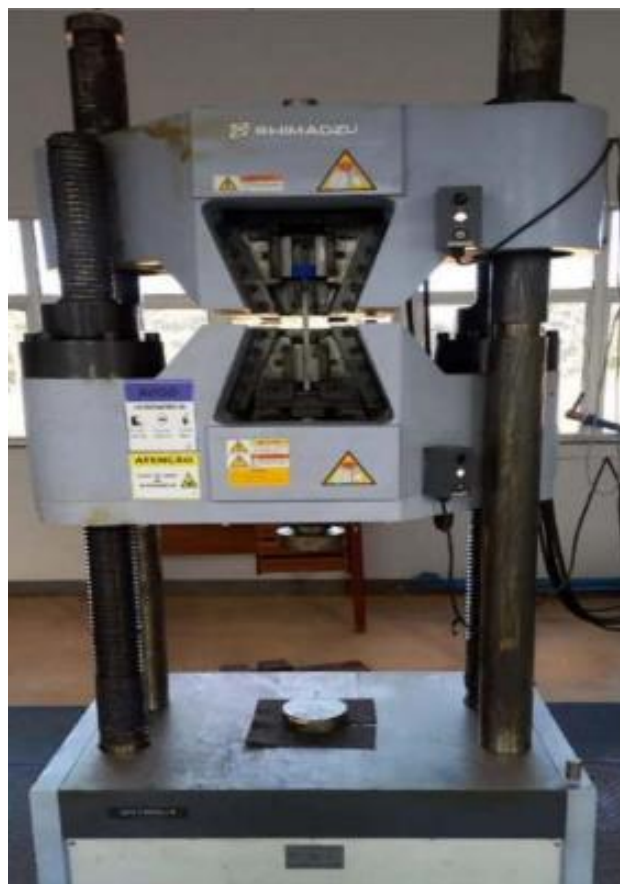
Figura 12 - Máquina servo-hidráulica de ensaios 600kN - Shimadzu UHF- 600
