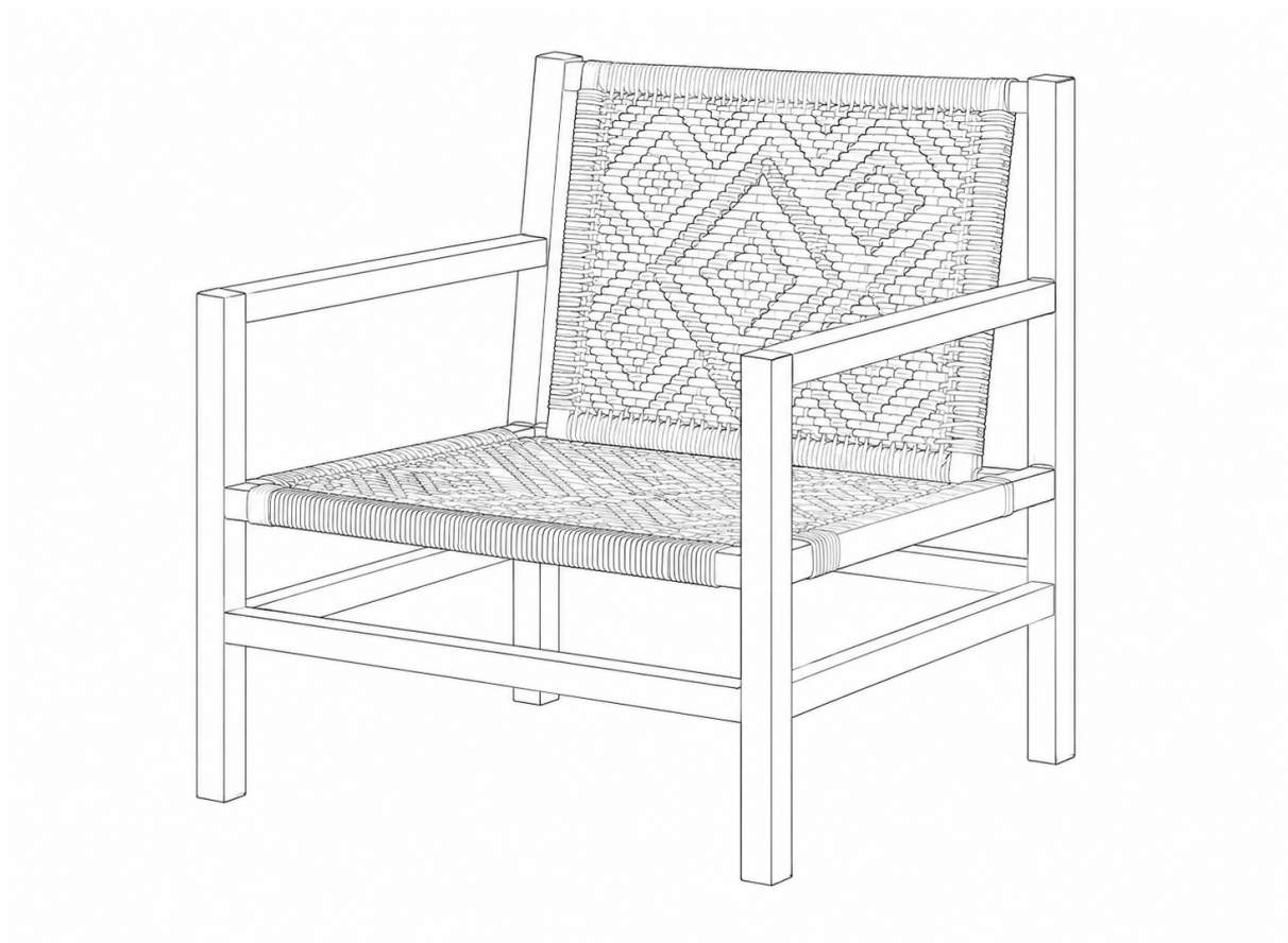
Figura 22 – Poltrona em estrutura metálica com pintura eletrostática com efeito amadeirado e assento em trama náutica trançada.
