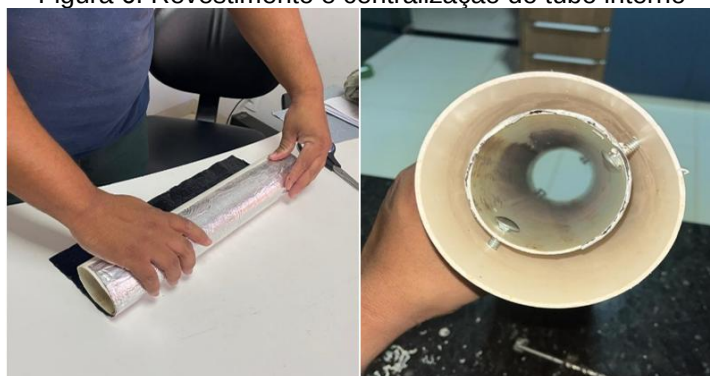
Figura 6. Revestimento e centralização do tubo interno
