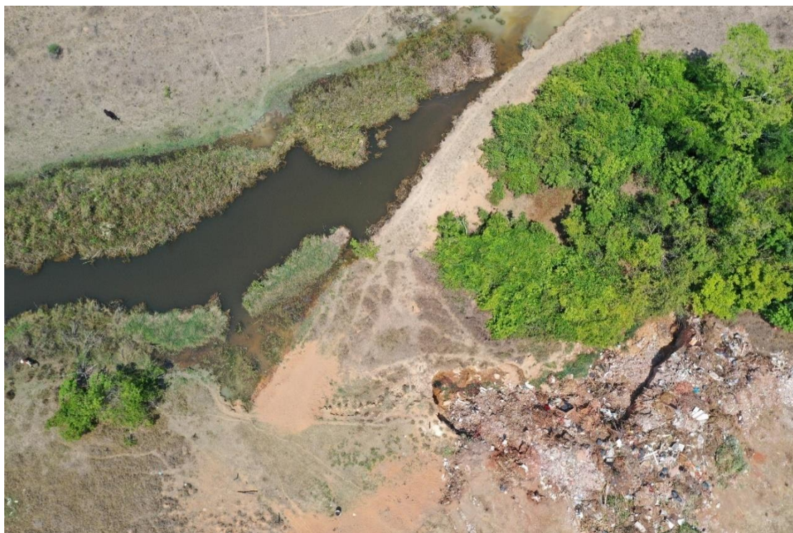
Figura 70: Voçoroca próxima a drenagem com descarte de entulho. Ponto 22TF02_021.
