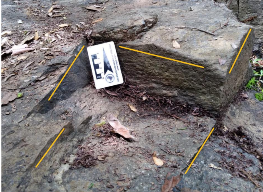
Figura 35: Representação das direções dos planos de fratura marcadas em linhas amarelas. Ponto 22TF02_172.
