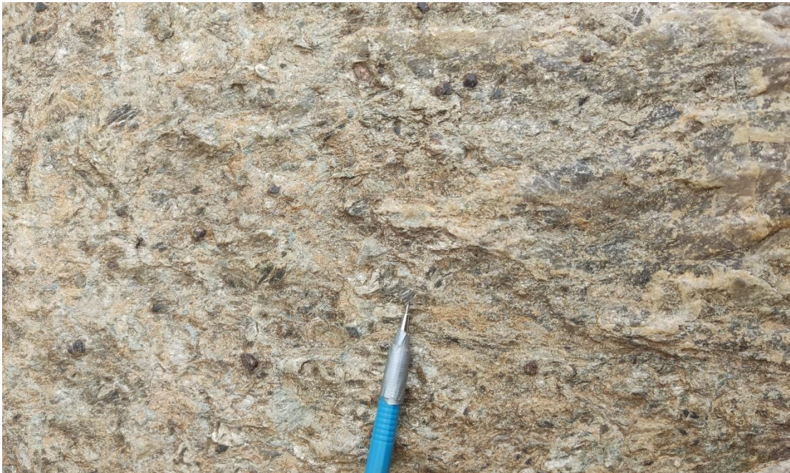
Figura 21: Amostra macroscópica do ponto 22TF01_109 do Hbl-Grt-Ms-Chl-Bt Xisto onde pode-se observar xistosidade e fenocristais de granada. Imagem cedida pela Área 1.
