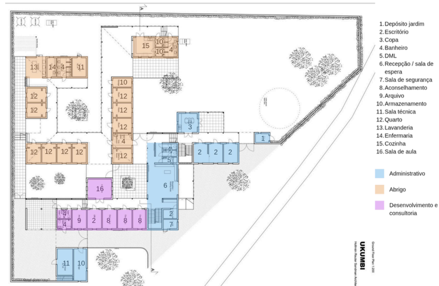
Planta baixa do edifício.
