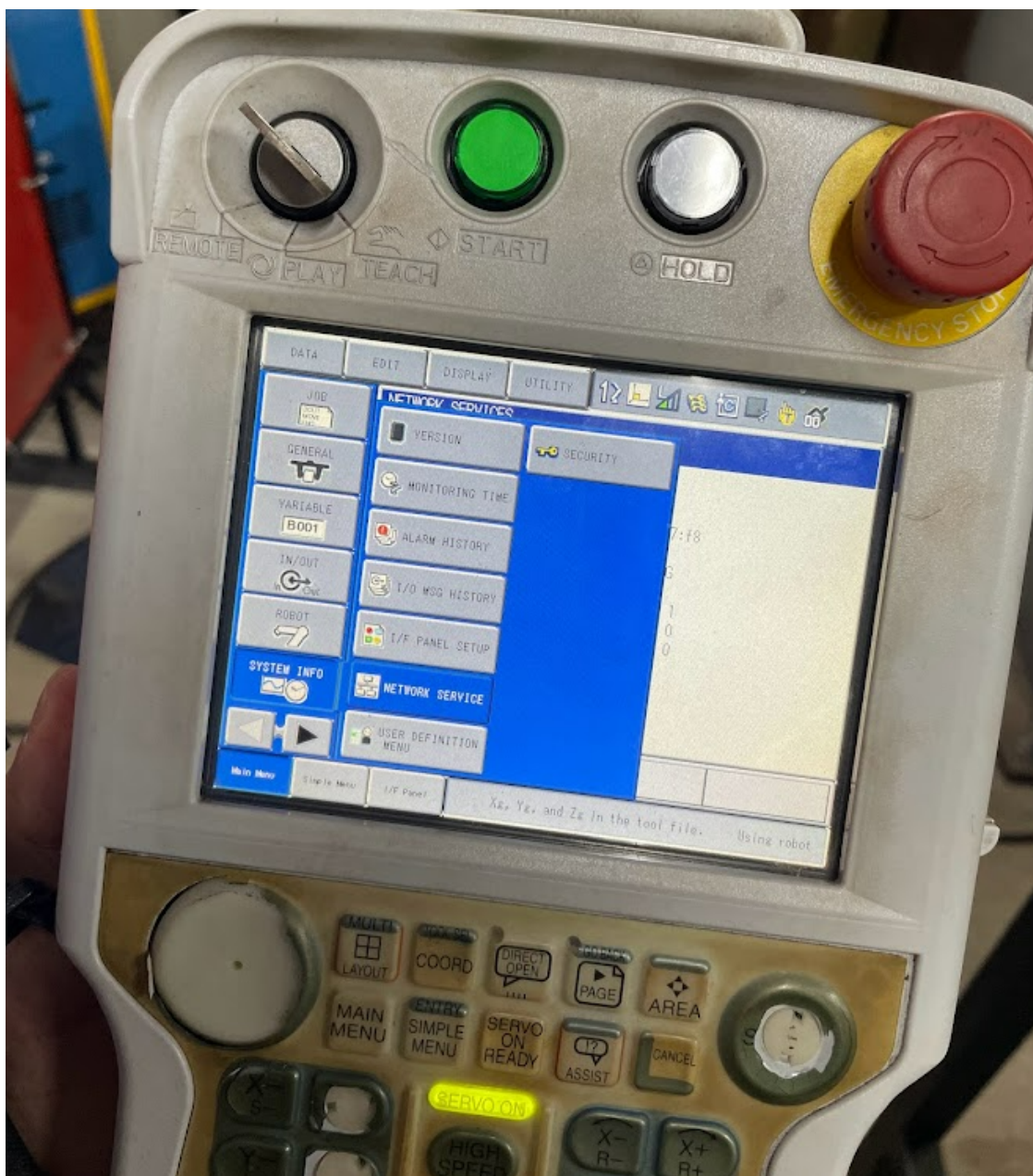
Figura 09: Acesso a configuração de IP do robô no controle manual na opção “Network Service”
