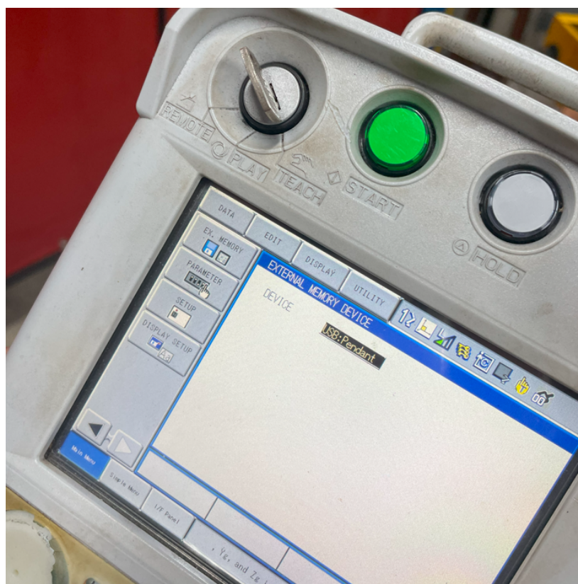
Figura 19: Carregando o conteúdo do Pen Drive no controle DX-100
