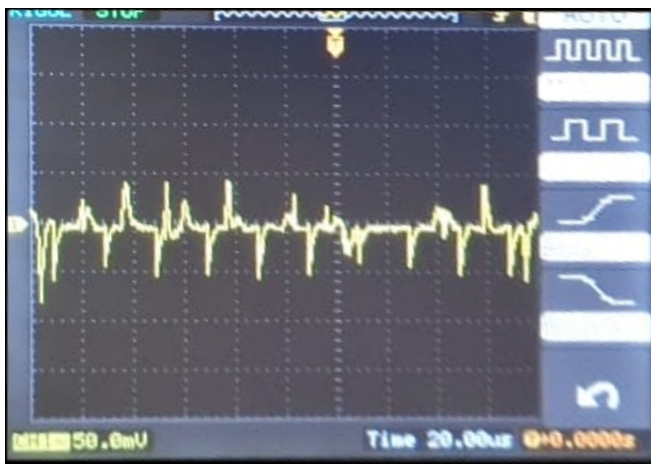
Fig. 28 – Ruído presente no pino AGND no projeto antigo com PWM = 70% .
