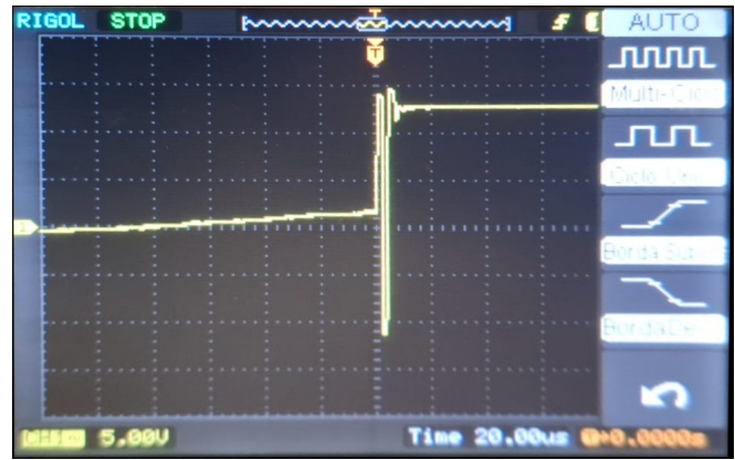
Fig. 29 – Ruído presente na fase do motor no projeto antigo com PWM = 70% .
