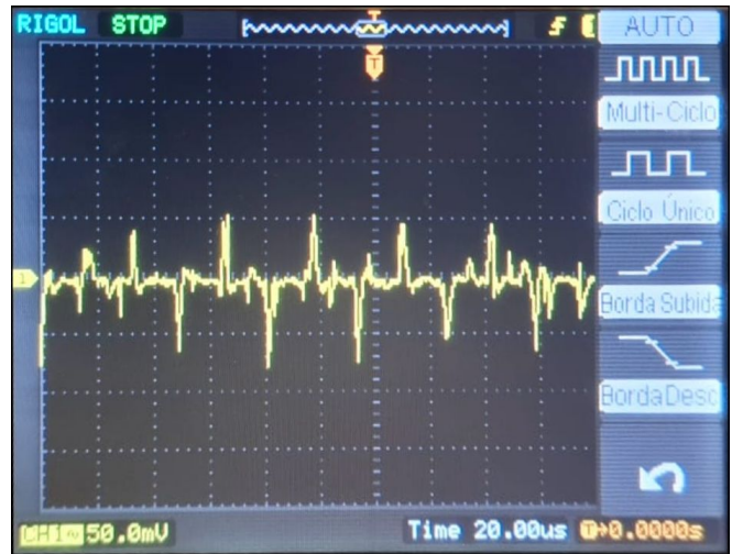
Fig. 26 – Ruído presente no pino AGND no projeto antigo com PWM = 60% . Fonte: Autor
