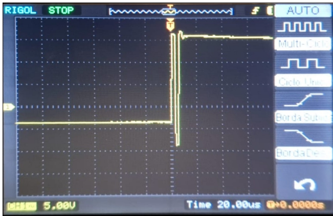
Fig. 27 – Ruído presente na fase do motor no projeto antigo com PWM =60% .
