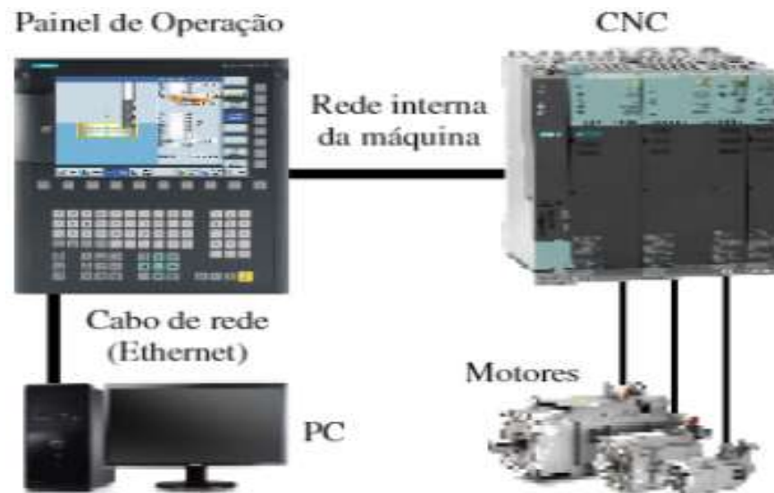
Figura 2 - Arquitetura de um Sistema de Monitoramento e Controle Remoto de um CNC ROMI D800 com controlador Sinumerik 828D
