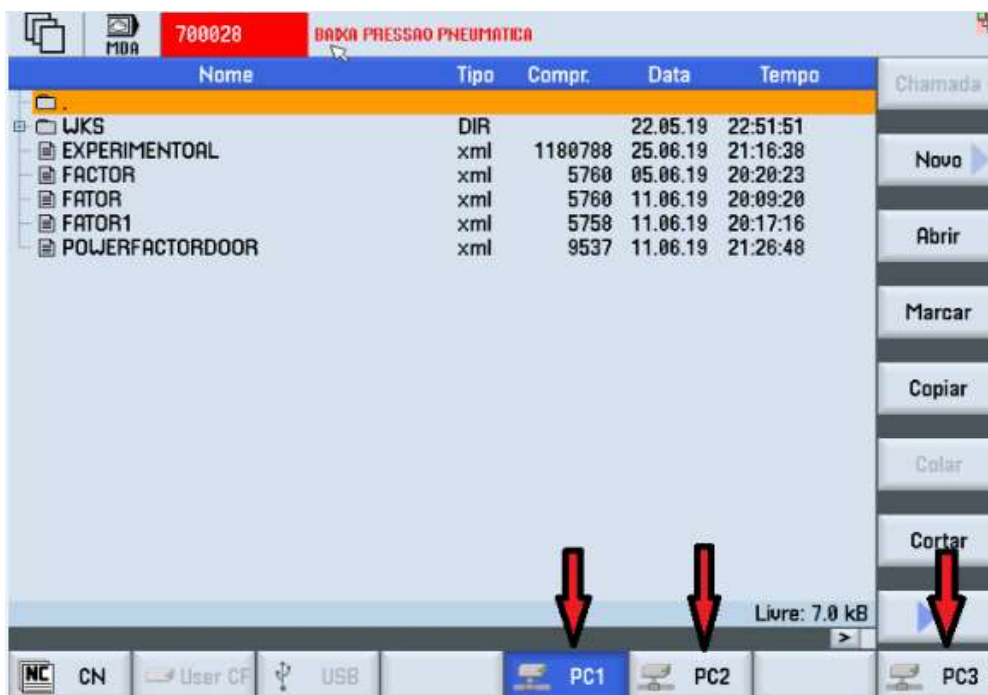
Figura 24 - Pastas compartilhadas na rede para troca de dados com o Sinumerik 828D
