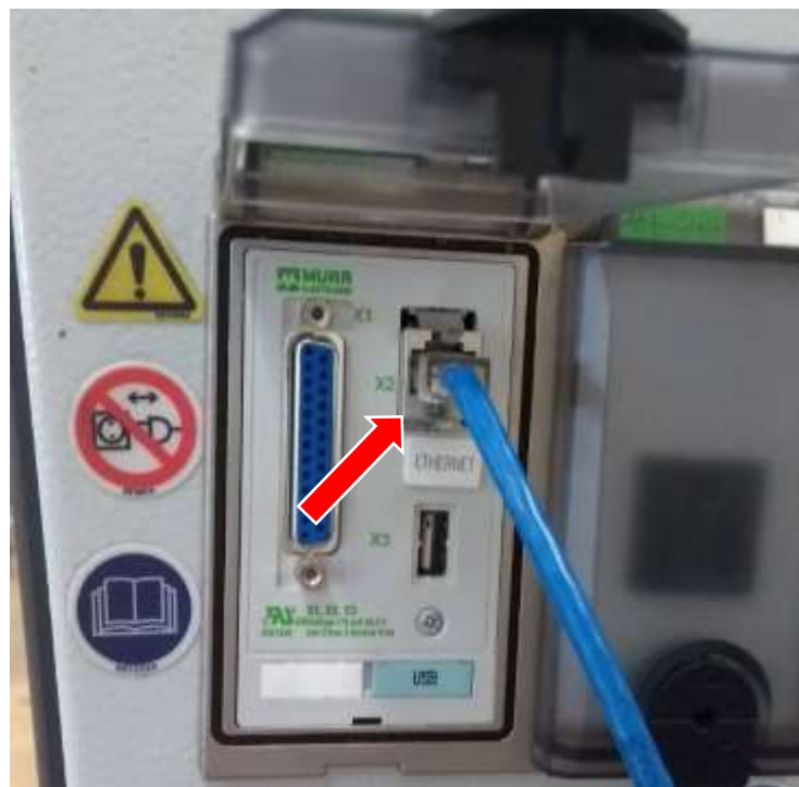
Figura 8 – Fotografia da porta X130 para comunicação em uma rede corporativa
