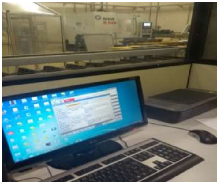
Figura 23 - Acesso remoto à HMI da máquina pelo PC na sala técnica do LAMAF
