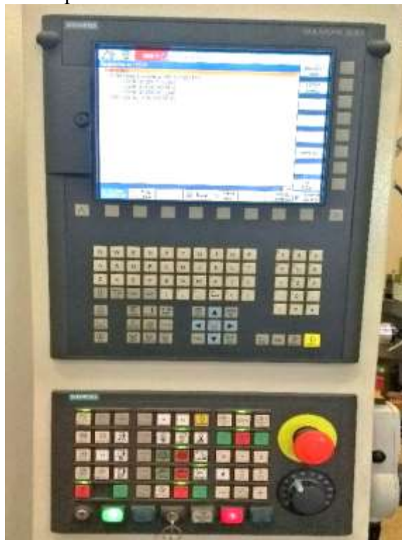
Figura 6 - Fotografia do painel de comando do Centro de Usinagem ROMI D600
