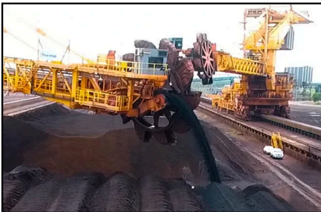
Figura 3: Stacker e Reclaimer (Empilhadeira Recuperadora)
