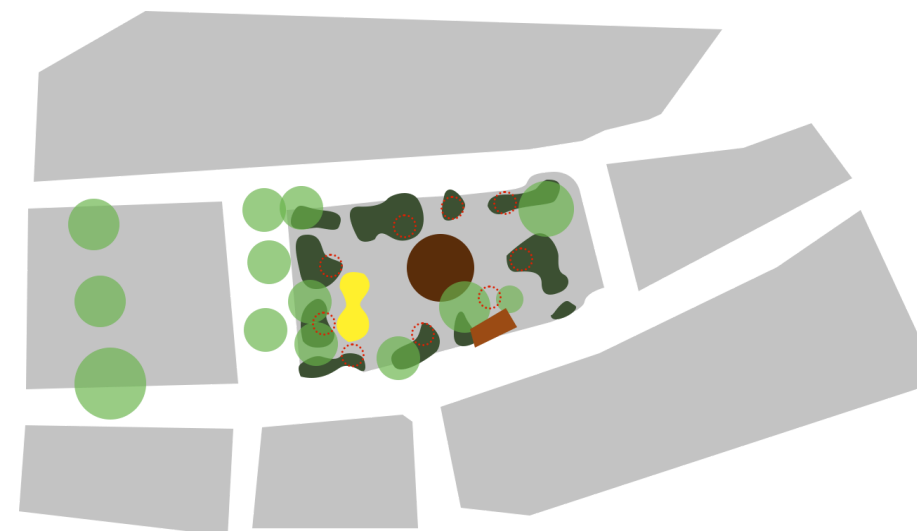
Figura 57 – Pontos de apoio à estrutura (círculos vermelhos).
