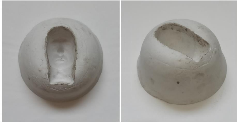
Figura 123 – Molde de gesso para produção das cabeças em argila. 2023. Gesso. 11 x 11 x 9 cm.
