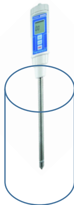
Figura 1: Esquema da instalação do sensor de umidade DSMM500 no anel amostrador.
