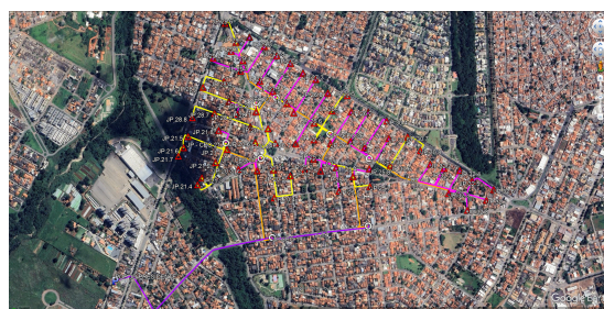
Fig. 35. Distribuição de elementos passivos e cabos(Google Earth)
