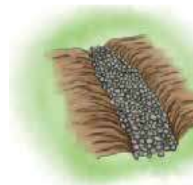
Imagem 16: Vala de drenagem
