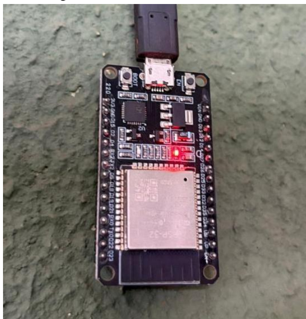
Figura 4.3 ESP32 Instalado na Usina
