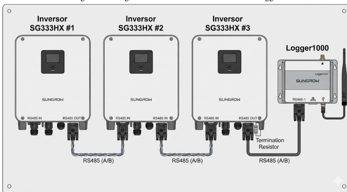
Figura 3.1. Diagrama de conexão dos inversores e datalogger
