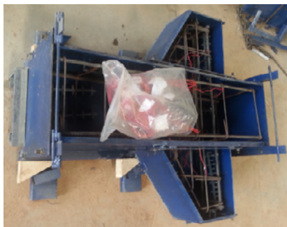
(a) Fôrma para concretagem do modelo monolítico
