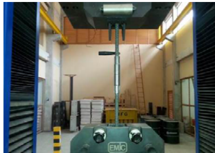
(a) Realização do ensaio de tração
