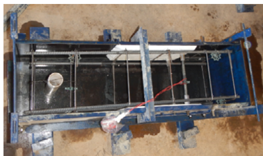
(b) Fôrma para concretagem do pilar do modelo com consolo moldado em etapa posterior
