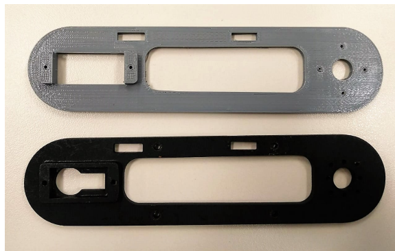
Figura 18. Peça do elo 2 que conecta as juntas 2 e 3, abaixo a peça original, acima a nova peça impressa em impressora 3D.
