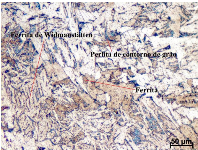
Fig. 44: Microestrutura da parte superior - ampliação de 200x.
