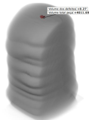
Fig. 31: Visualização no tomógrafo - espécime de 15 L/min.
