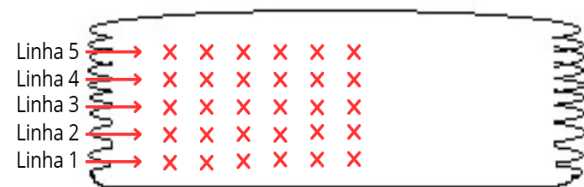
Fig. 16: Representação do ensaio de dureza
