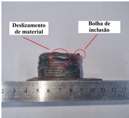
Fig. 26: Espécime fabricado com 25 L/min.
