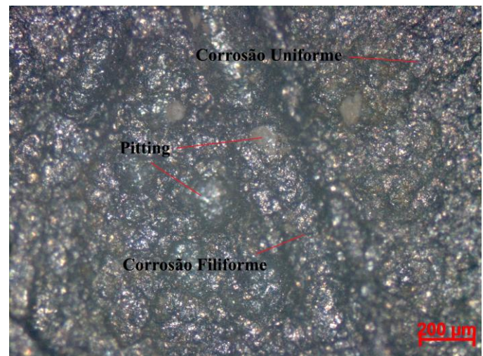
Fig. 58: Amostra \text{Cl}_2+\text{H}_2\text{O} - Ampliação de 50x.
