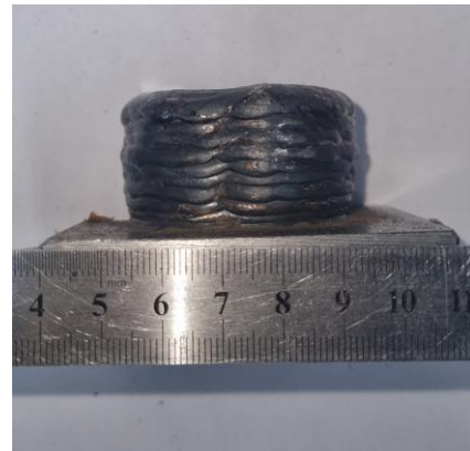
Fig. 25: Espécime fabricado com 30 L/min.
