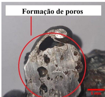
Fig. 22: Vista na região de corte do espécime de 10 L/min.
