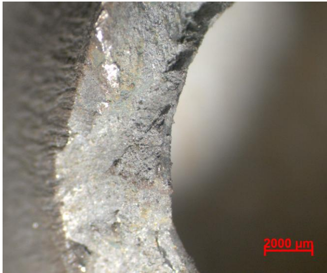
Fig. 48: Primeira vista superior da região de ruptura do tubo - ampliação de 2,5x.
