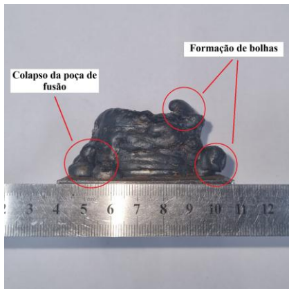
Fig. 21: Espécime fabricado com 10 L/min.
