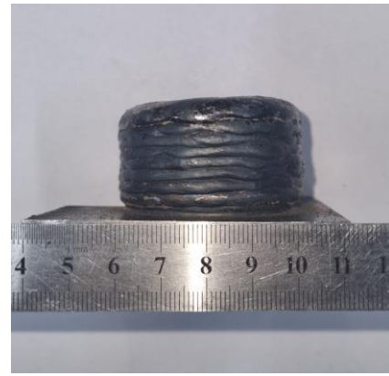
Fig. 23: Espécime fabricado com 15 L/min.
