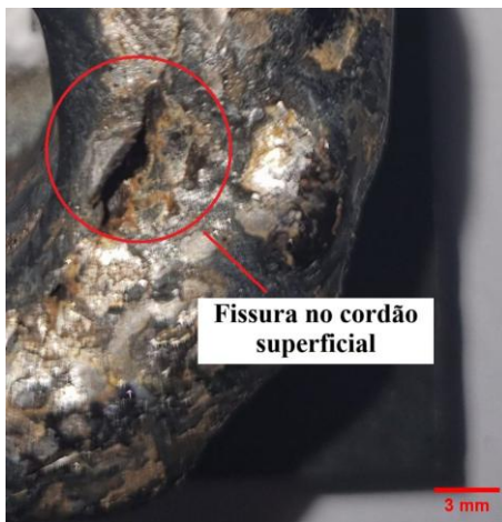
Fig. 27: Vista superior do espécime de 25 L/min.
