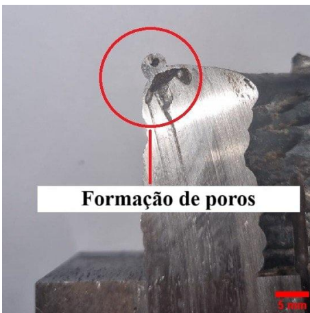
Fig. 28: Vista na região de corte do espécime de 25 L/min.
