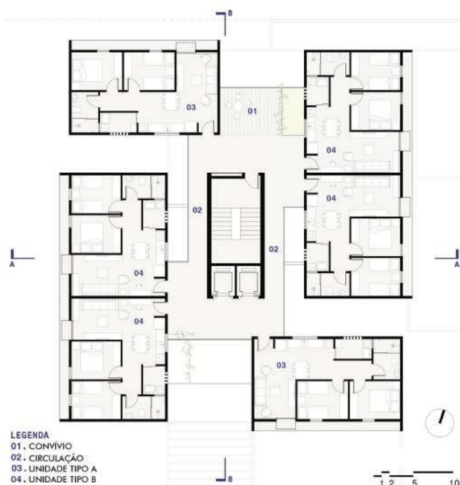
Figura 37: Planta pavimento tipo. Fonte: SOUZA (2017).
