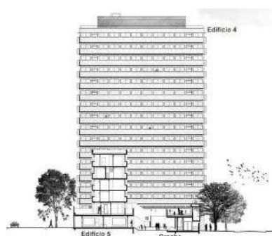
Figura 34: Corte transversal creche. Fonte: OLCZYK (2015).
