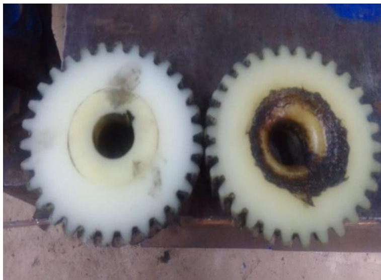
Figura 15. Desgaste engrenagens devido aquecimento
