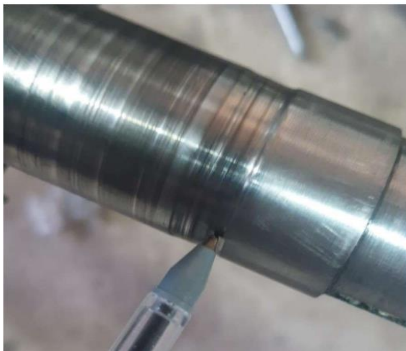
Figura 14. Eixo desgastado por rolagem
