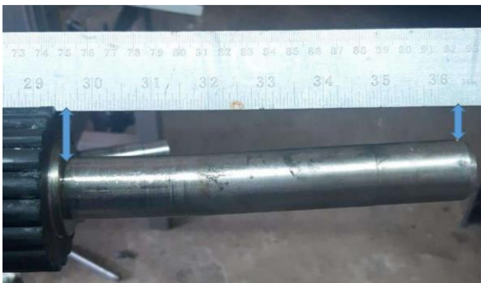
Figura 12. Eixo empenado devido esforços e aquecimento
