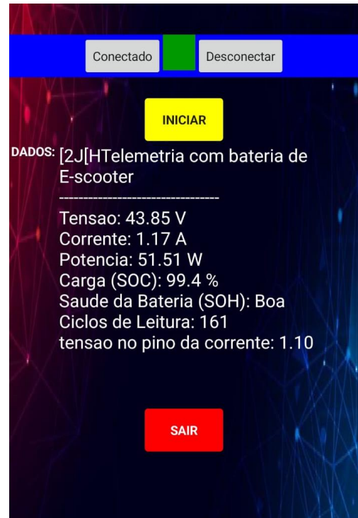
Figura 28: Resultados obtidos no aplicativo móvel na bancada de testes do laboratório de motores elétricos da EMC. Fonte: Autor.
