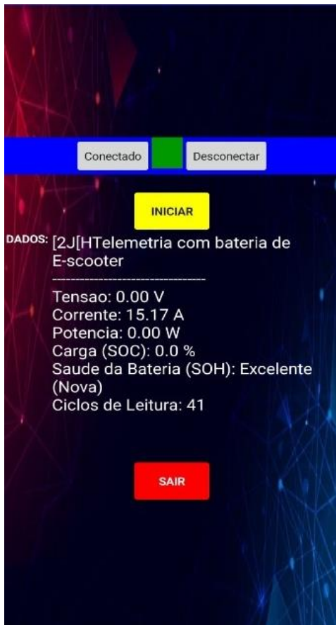
Figura 24: Design do aplicativo móvel Bluetooth e validação da conexão com o microcontrolador. Fonte: Autor.
