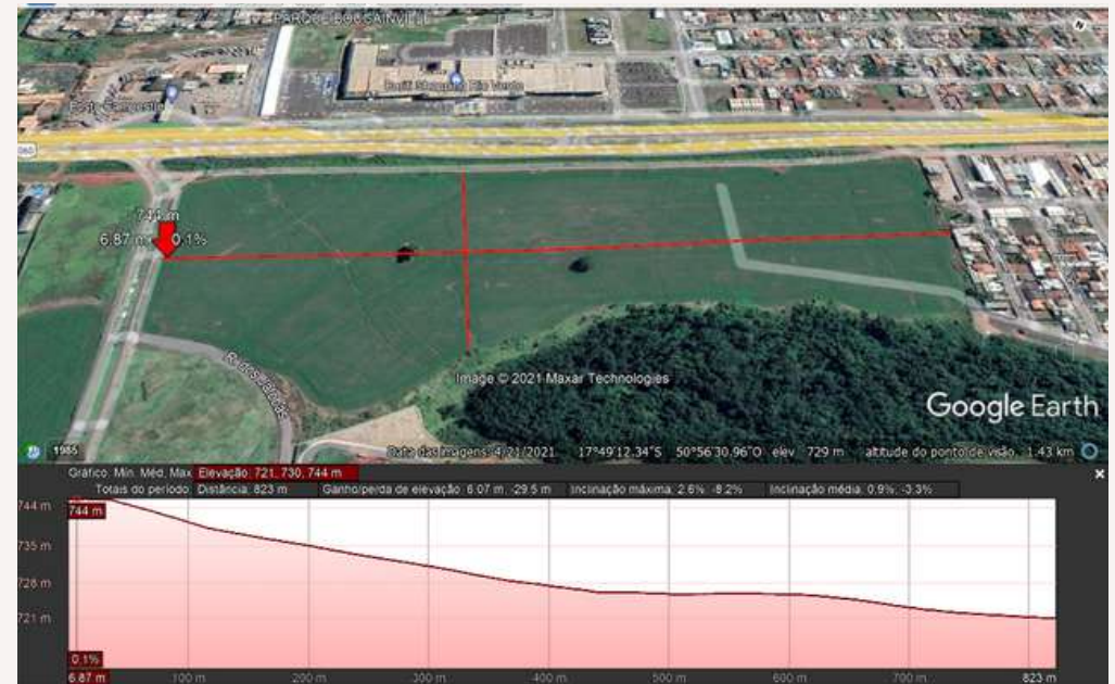
Imagem 95. Perfil de elevação longitudinal. Neste sentido o terreno apresenta 23 metros de desnível, sendo mais alto na lateral esquerda. Fonte: Google Earth.
