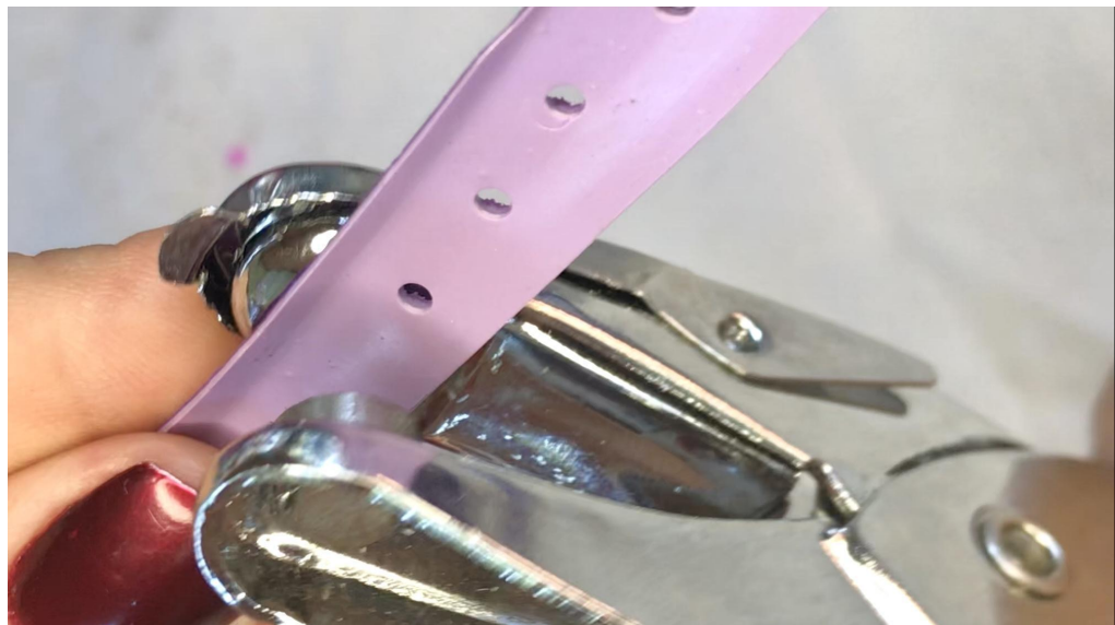
Figura 10 – Perfuração das tiras de PEAD com furador metálico para criação das lantejoulas artesanais
