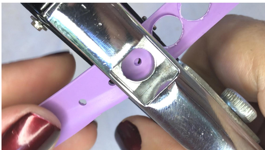
Figura 11 – Perfuração das tiras de PEAD com furador metálico para criação das lantejoulas artesanais
