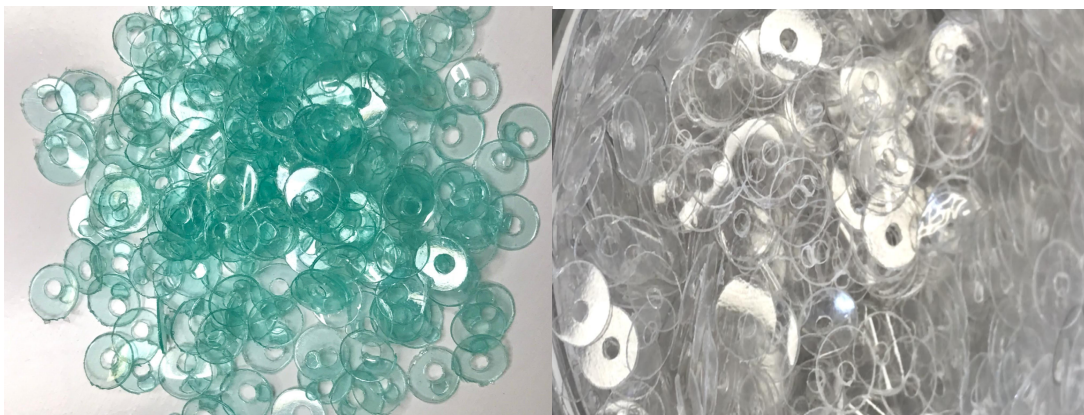
Figura 13 – Lantejoulas de PET transparentes e verdes após corte e perfuração
