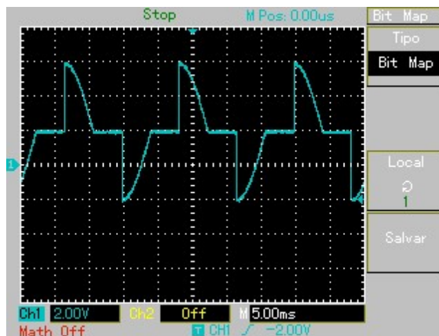
Figura 26 - Forma de Onda Característica de um Retificador Monofásico Com Offset Positivo
