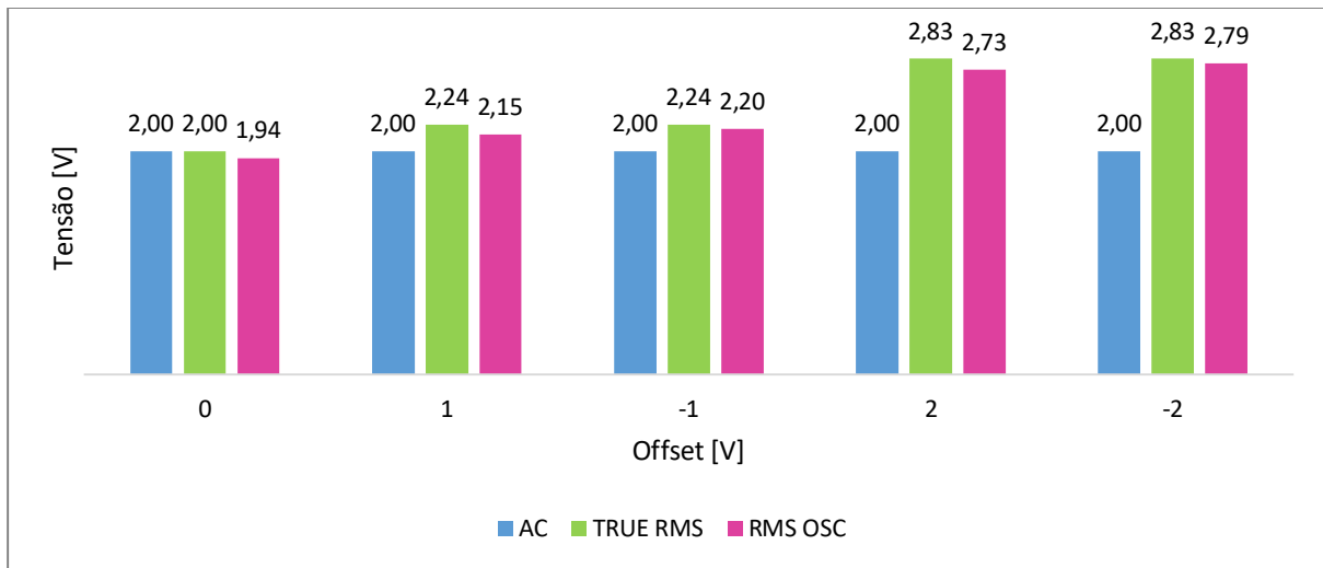
Figura 30 - Gráfico Comparativo de Valores Teóricos e Valores Medidos pelo Osciloscópio para Onda Quadrada
