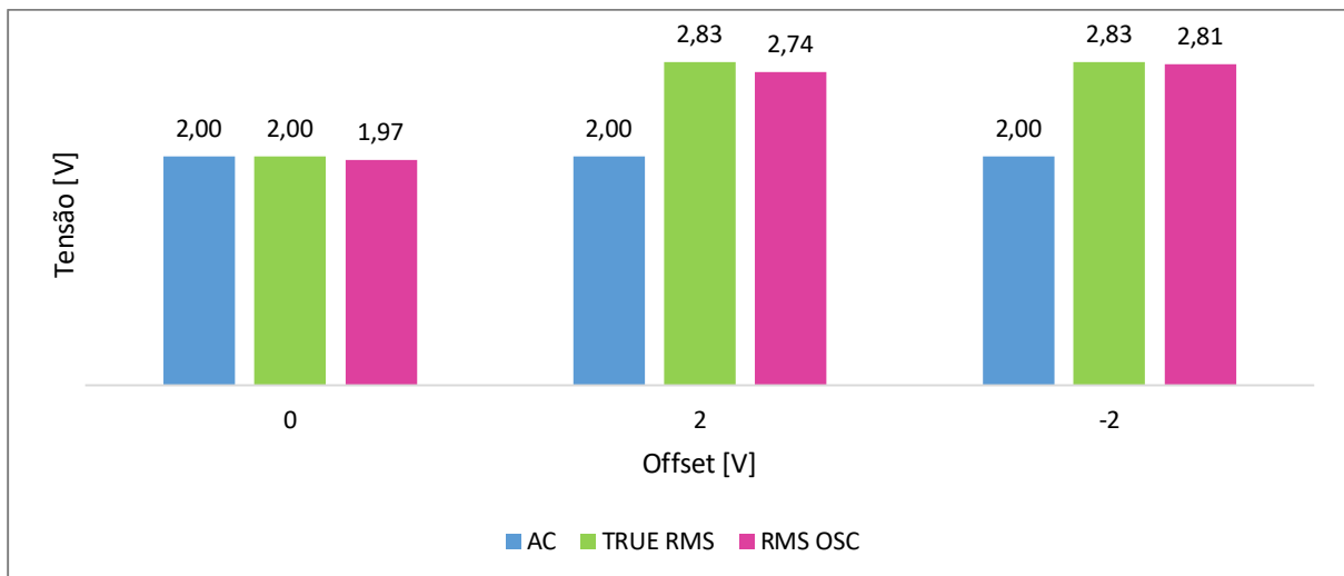
Figura 31 - Gráfico Comparativo de Valores Teóricos e Valores Medidos pelo Osciloscópio para Onda Típica de um Conversor Multinível.
