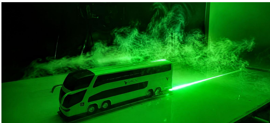
Figura 4.10. Visualização do escoamento em torno do modelo iluminado por plano laser verde
