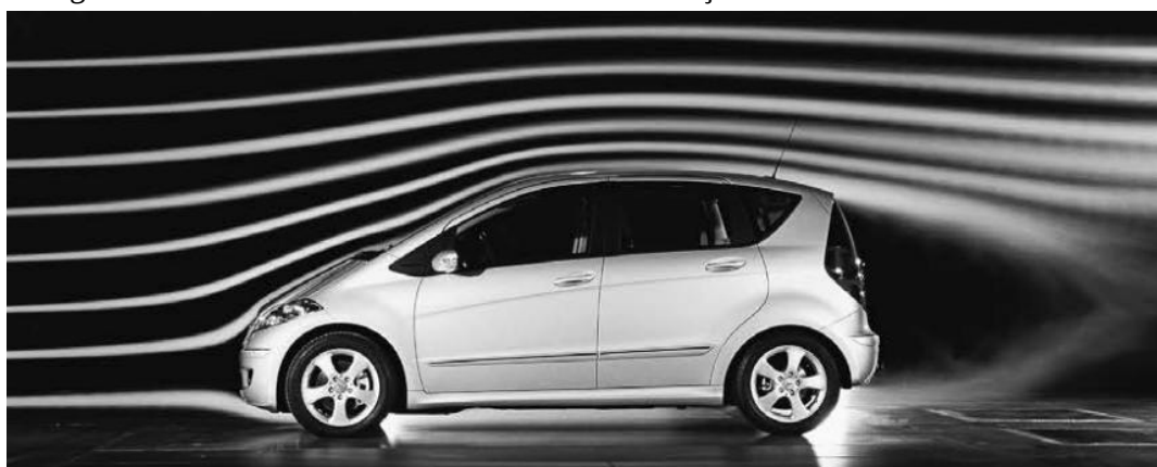
Figura 2.2. Linhas de emissão sobre o veículo na seção de teste de um túnel de vento.
