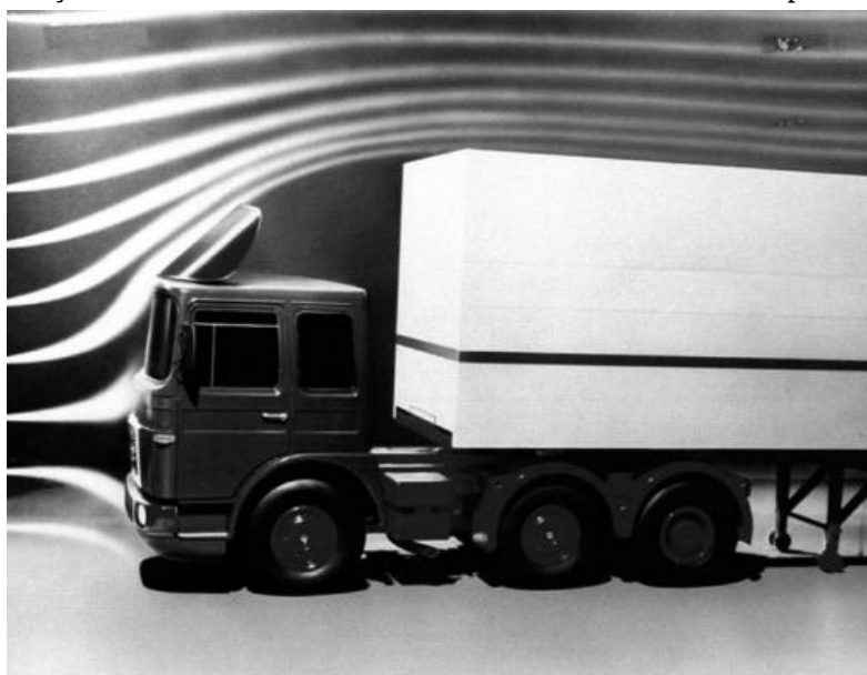
Figura 2.5. Aplicação de defletor aerodinâmico frontal em veículo de transporte de carga pesado
