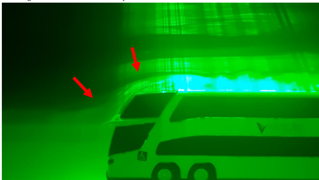
Figura 5.1. Escoamento de fumaça sobre o modelo com feixe de laser na frente do veículo.
