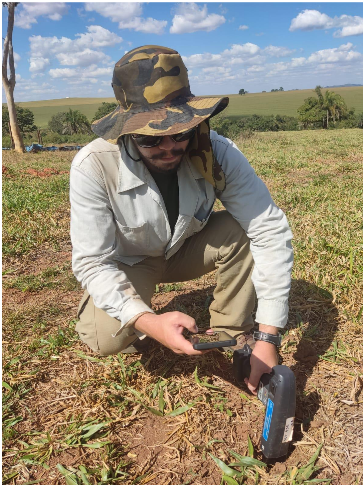
Figura 11. Aquisição de medidas de susceptibilidade magnética do solo, realizada em campo. Os valores da susceptibilidade são adquiridos quando os valores lidos pelo equipamento de estabilizam, o que ocorre a partir de 10 s após o encaixe do equipamento na cavidade aberta. Após a estabilização, as 5 leituras são coletadas de forma sequencial.
