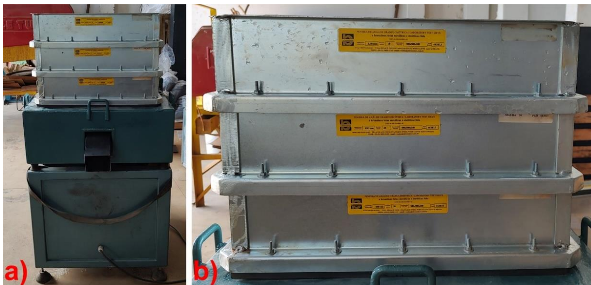
Figura 17. a) agitador de peneiras completamente montado; b) grupo de peneiras utilizadas no laboratório.
