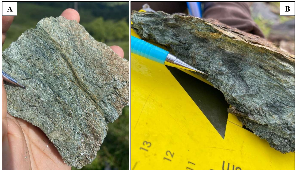
Figura 23 - (A) Amostra evidenciando as acículas de tremolita. (B) Amostra de mão evidenciando clivagem de crenulação.
