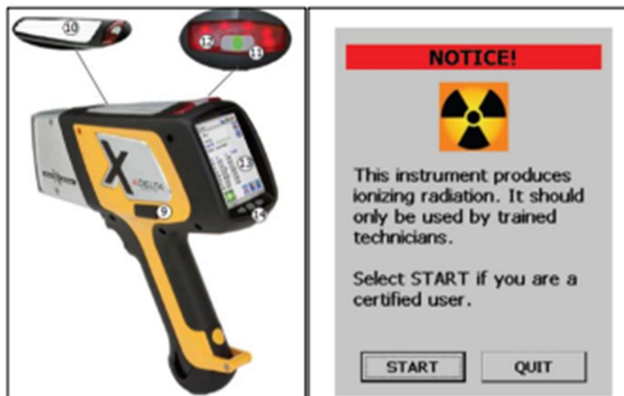
Figura 57 - Fluorescência de Raios-X Portátil (Delta-x Olympus). Fonte: Manual de Instrução Técnica (Olympus, 2012).
