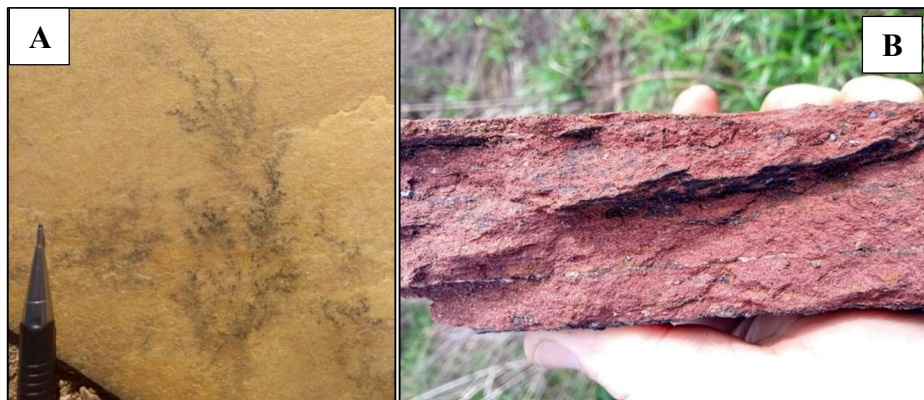
Figura 67 - (A) Óxidos de manganês em hábito dendrítico em quartzito do Grupo Serra Dourada, ponto 104. (B) Óxido de manganês nos planos de foliação em micaxisto, ponto 66.
