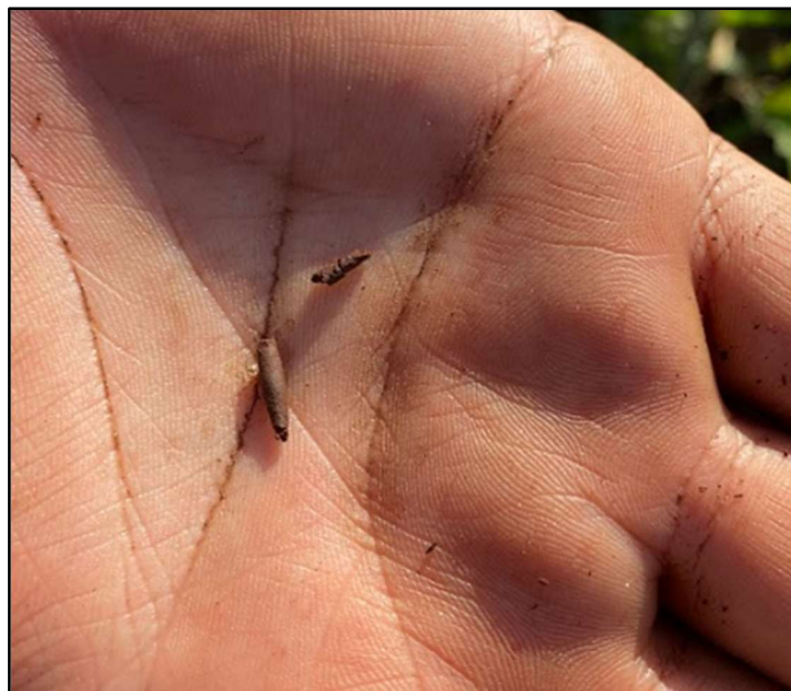
Figura 7 - Teste de plasticidade no solo, evidenciando a presença de argila no mesmo.
