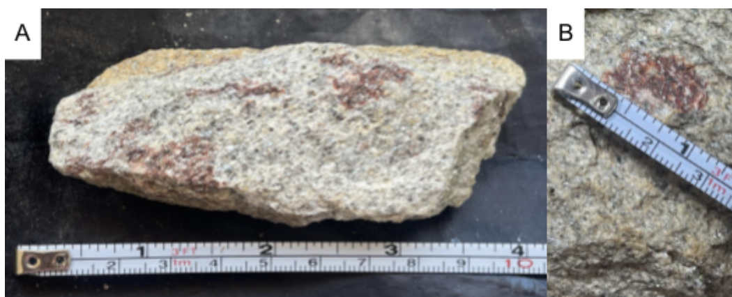
Figura 26: Gnaisses provenientes dos blocos rolados no ponto 111, contendo granadas centimétricas que transpõem a foliação. Litofácies 3: Granada-muscovita gnaissse.
