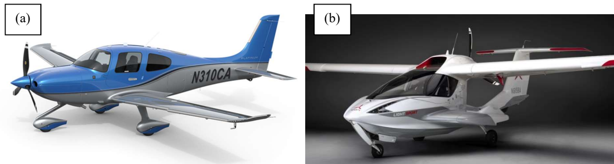
Figura 2 – (a) Aeronave com configuração tractor. (b) Aeronave com configuração pusher
