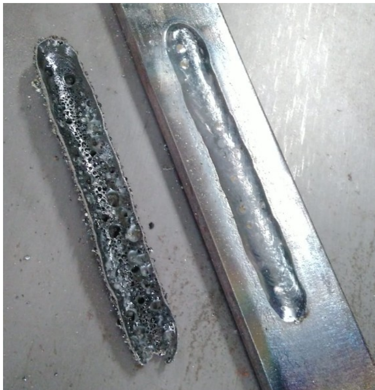
Figura 13: Amostra 2 - Cordão de solda de arco submerso e escória de soldadura
