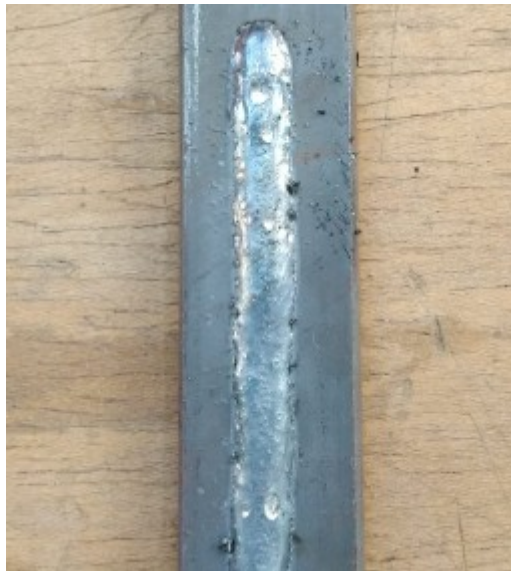
Figura 19: Amostra 3 -Cordão de solda arco submerso sem retirar carepa de laminação.
