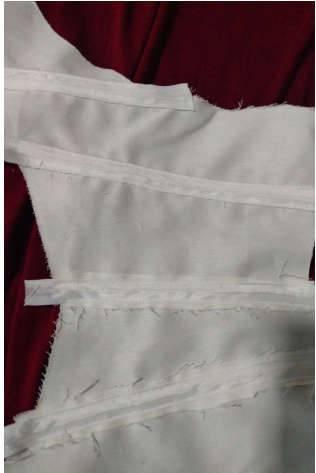
Figura 42 - Canaletas finalizadas e refiladas
