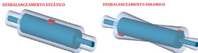
Figura 13 – Exemplificação de vibração em rotores desbalanceados.
