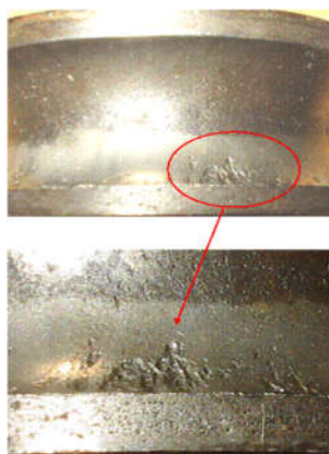
Figura 17 – Defeito na pista externa de um rolamento.
