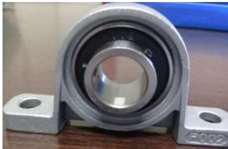
Figura 24 – Mancal de rolamento Kp002 utilizado na bancada.
