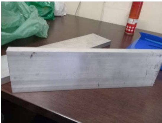
Figura A1 - Material utilizado na fabricação dos módulos dos mancais de rolamento.
