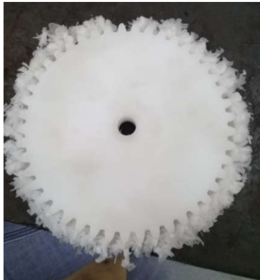
Figura A3 – Rebarbas na engrenagem coroa.
